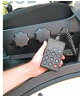
Для управления пневмоподвеской при разгрузке есть вот такой небольшой пульт
