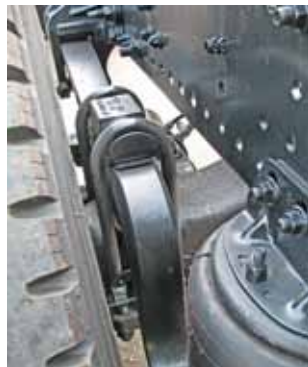
Задняя пневмоподвеска сделана на однолистных Z-образных полурессорах...
