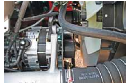
Привод генератора и водяного насоса – поликлиновым ремнем
