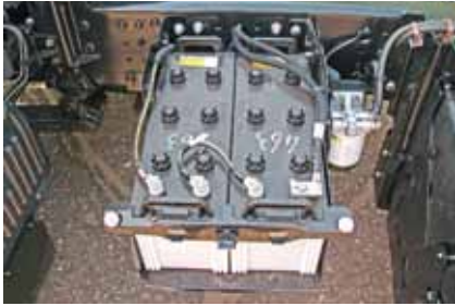
Аккумуляторы довольно герметично закрыты пластмассовой крышкой
