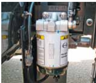
У японцев небольшой по объему топливный фильтр-отстойник
