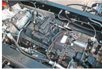
Японская 6-ступенчатая коробка – с чугунным картером и верхней крышкой
