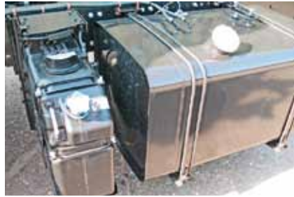
Топливный бак – стальной, на 390 литров и на 28 л для AdBlue
