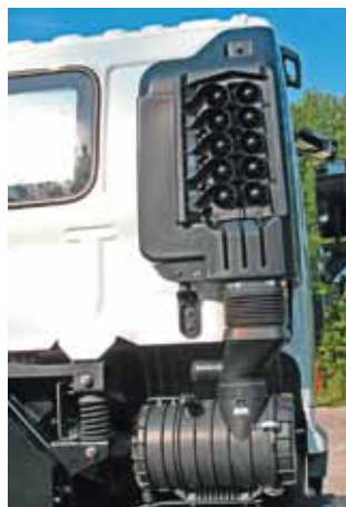
Воздушный фильтр расположен удачно – за кабиной. На входе – что-то похожее на циклон
