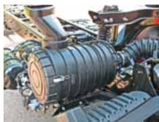
Крышка корпуса фильтра крепится на трех защелках. Для России маловато...
