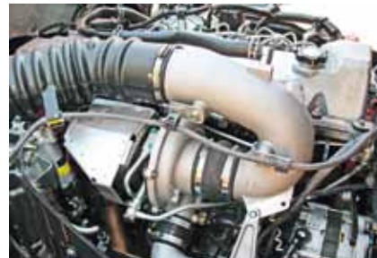
Турбина – без электронной регулировки производительности
