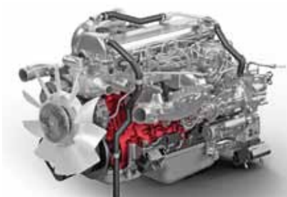
Блок мотора с «сухими» гильзами. Распредвал размещен в головке
