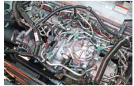
Топливная аппаратура – Common Rail производства Denso
