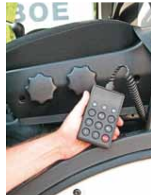
Для управления пневмоподвеской при разгрузке есть вот такой небольшой пульт
