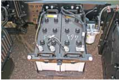
Аккумуляторы довольно герметично закрыты пластмассовой крышкой
