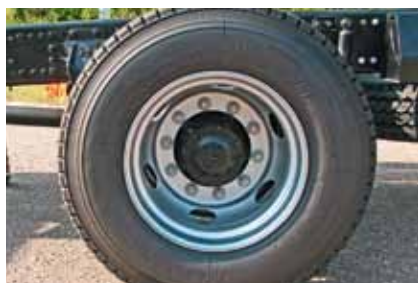
Крепление колес без футорок, по международному стандарту ISO
