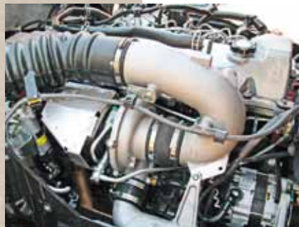
Турбина – без электронной регулировки производительности
