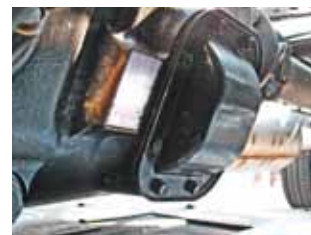
На коробке Hino есть лючок под отбор мощности и привод гидронасоса
