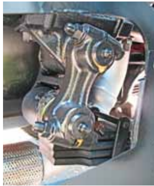
Обычно самые изнашиваемые рессорные втулки и пальцы – в серьгах
