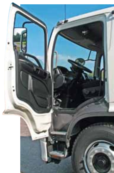
У 500 GH на больших колесах две ступени, а у трехосного Hino 500 GM – три
