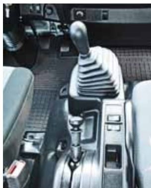
Пневмокран стояночного тормоза на консоли, за рычагом коробки передач
