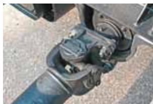
Раньше крепление чашек крестовин было пластиной и двумя болтиками...
