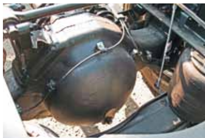
Балка моста отлита из стали, рассчитана на нагрузку 11,5 тонны
