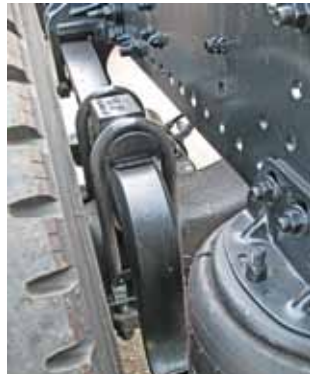
Задняя пневмоподвеска сделана на однолистовых Z-образных полурессорах...
