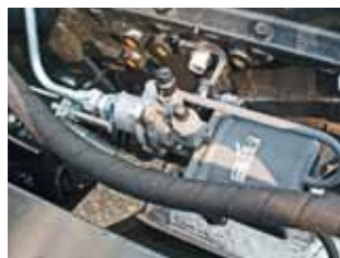
На коробке Hino есть пневмогидроусилитель сцепления – педаль легкая
