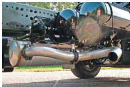
Глушитель без сажевого фильтра, но с системой нейтрализации SCR
