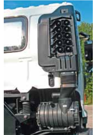
Воздушный фильтр расположен удачно – за кабиной. На входе – что-то похожее на циклон
