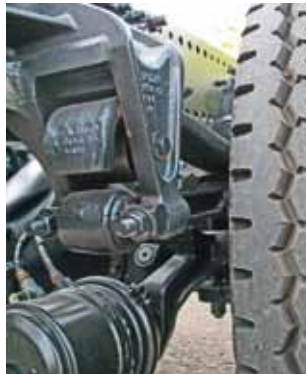
...но впереди мост держит не полурессора, а реактивная штанга с сайлентблоками
