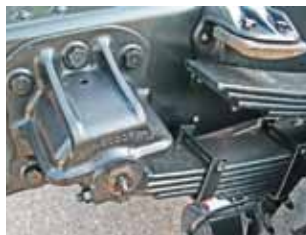
На кронштейны задних подвесок теперь ставят сменные чугунные накладки
