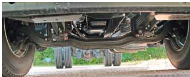
Передняя ось рассчитана на 6,5 т. Здесь рессорная подвеска и есть стабилизатор поперечной устойчивости
