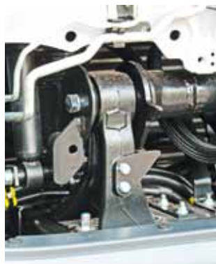
...впереди пружины подвески толком и не видны. Амортизаторы легко заменить
