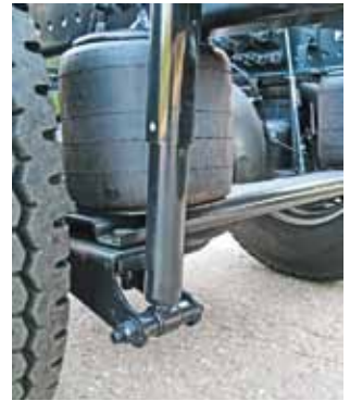
Задняя пневмоподвеска сделана по двухбаллонной схеме с верхней тягой Панара
