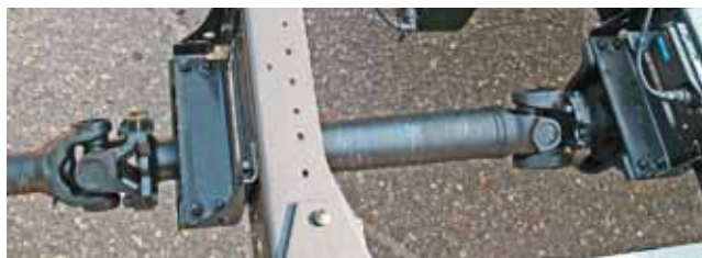
Для длиннобазовых шасси приходится оснащать карданный вал двумя подвесными подшипниками
