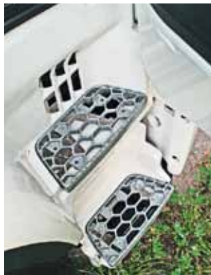
Все ступени лестницы сделаны решетчатыми – снег и наледь будут проваливаться
