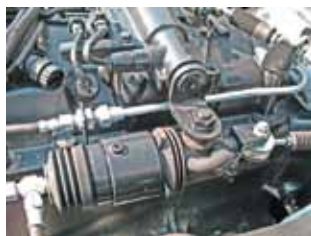
В приводе японской коробки есть пневмоусилитель механизма переключения
