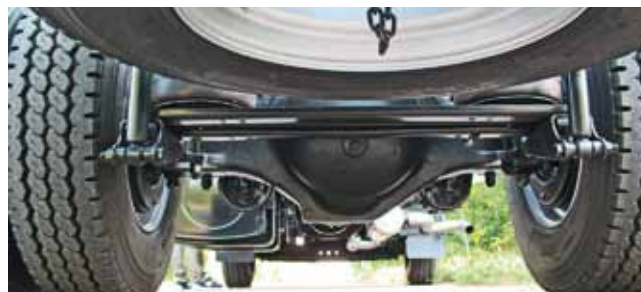
Опоры пневмобаллонов смонтированы на поперечной стальной балке. К ней же крепятся и задние концы полурессор
