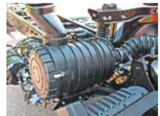
Крышка корпуса фильтра крепится на трех защелках. Для России маловато...
