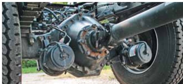
Ведущий мост – с одинарной гипоидной главной передачей, числа зависят от применяемой коробки. Блокировки дифференциала нет
