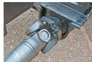
...теперь чашки фиксируются стопорным кольцом, у фланцев есть торцевые шлицы
