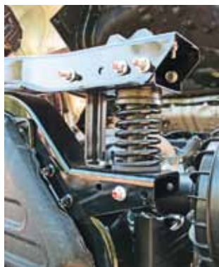
Подвеска кабины четырехточечная, на пружинных стойках...
