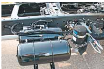
Здесь ресиверы стальные, а на 12-тонном были и алюминиевые
