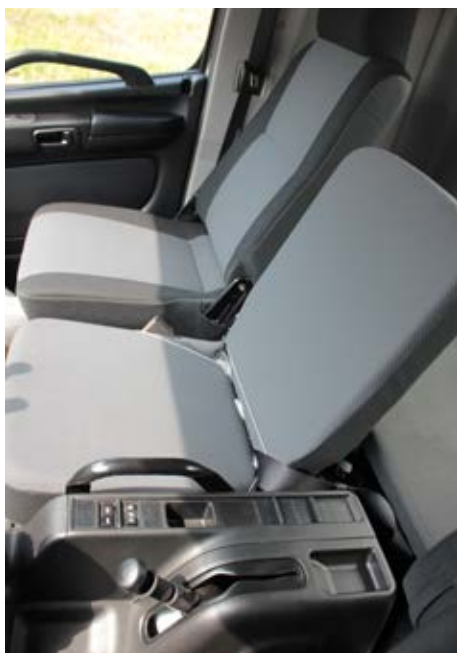
« Планировка кабины предусматривает помимо водителя ещё два посадочных места. Но центральное сиденье на моторном кожухе комфортным не назовёшь, зато оно складывается и получается столик ⤴
