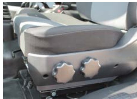
⤴ Регулировок сиденья не слишком много, но вполне достаточно, а рулевая колонка регулируется по вылету и углу наклона ⤴ ⤵ в очень широком диапазоне
