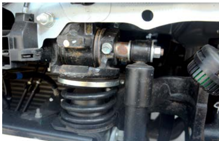
Подвеска кабины спереди на амортизаторных стойках, сзади – подпружиненная балка
