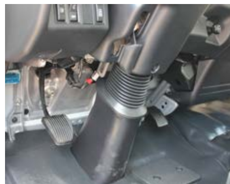
⤴ Регулировок сиденья не слишком много, но вполне достаточно, а рулевая колонка регулируется по вылету и углу наклона ⤴ ⤵ в очень широком диапазоне
