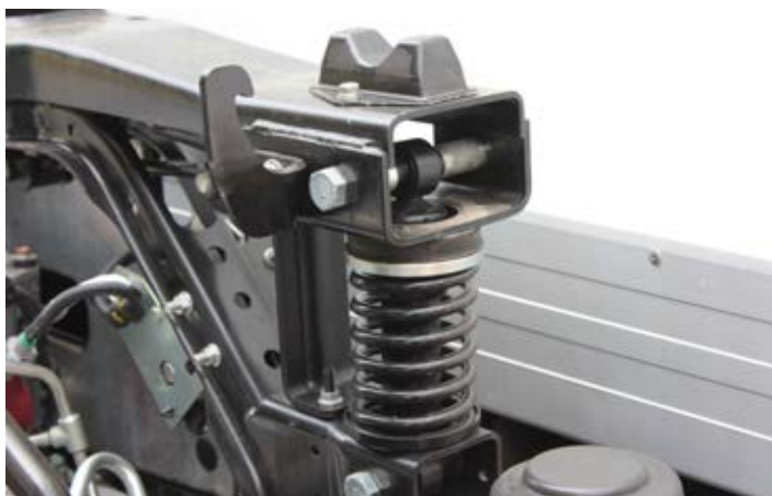
Подвеска кабины спереди на амортизаторных стойках, сзади – подпружиненная балка
