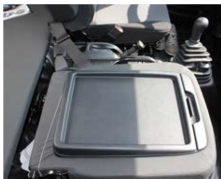
« Планировка кабины предусматривает помимо водителя ещё два посадочных места. Но центральное сиденье на моторном кожухе комфортным не назовёшь, зато оно складывается и получается столик ⤴
