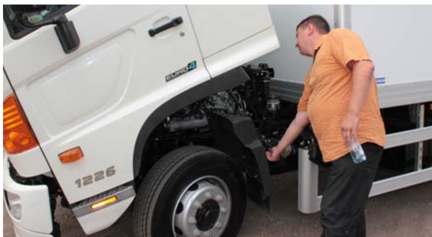
Кабина поднимается при помощи гидроэлектрического привода, сначала снимаем страховочный фиксатор, затем переводим кран в рабочее положение и просто нажимаем на кнопку запуска электронасоса! Если разряжены аккумуляторы, то можно и вручную – на снимке виден захват под монтировку
