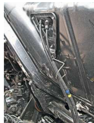
От селектора в кабине к самой автоматической коробке идут два троса управления
