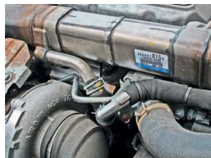
Жидкостный теплообменник рециркуляции отработавших газов
