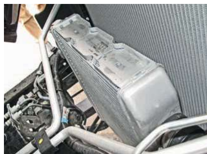
Это интеркулер, а теплообменник АКП вмонтирован в основной радиатор
