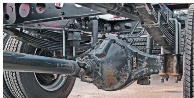
В гипоидном редукторе ведущего моста, в сравнении с механической КП, под «автомат» увеличили передаточное число
