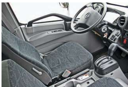
Селектор АКП смонтирован там же, где стоял рычаг механической КП
