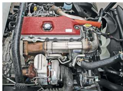
Привод ГРМ на этом двигателе – шестернями переднего расположения
