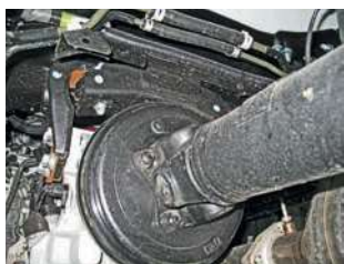
На вторичном валу смонтирован барабанный тормоз. Обслуживать его просто
