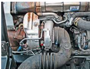
Турбина фирмы Honeywell с электроннорегулируемым направляющим аппаратом
