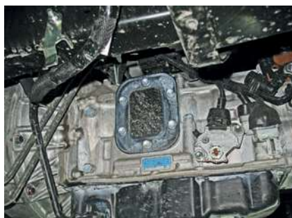
С левой стороны АКП есть лючки для монтажа коробки отбора мощности
