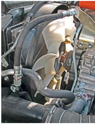
Привод вентилятора – надежным поликлиновым ремнем. Муфта вязкостная
